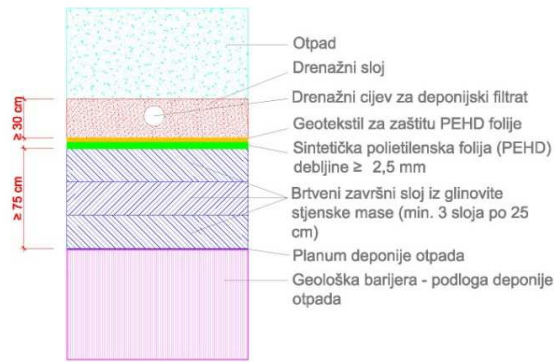
Slika 2: Donji brtveni sistem izgrađen prema Izvedbenom projektu
