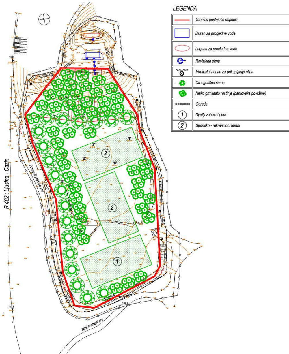
Slika 1: Situacija sanirane deponije "Krivodol"
